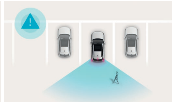
Aide au stationnement avec fonction freinage.
