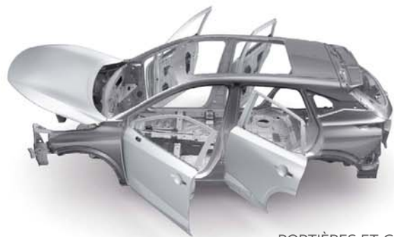
PORTIÈRES ET CAPOT EN ALUMINIUM Les panneaux de portes et le capot en aluminium, plus légers, aident à limiter le poids du véhicule et les émissions de CO 2 .
