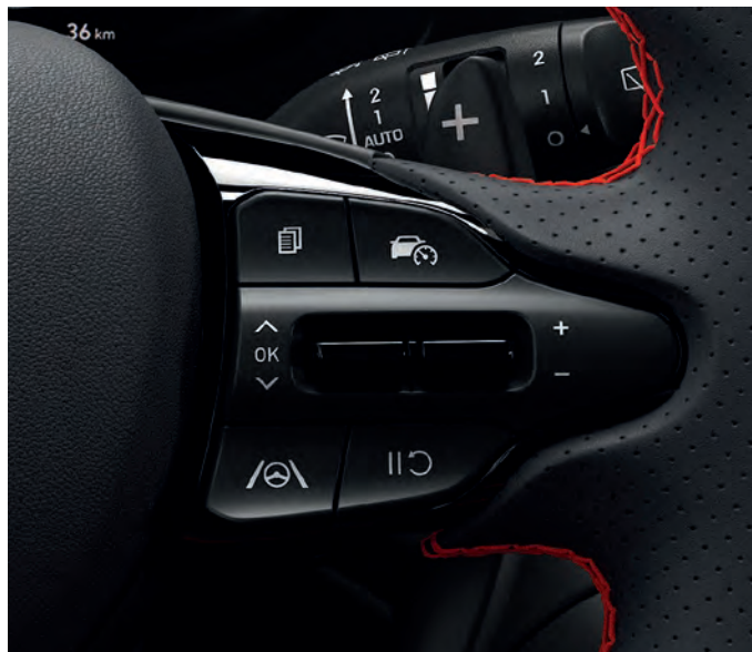
Vous aimez prendre le contrôle ? Avec la boîte de vitesses DCT-7, le volant est équipé de palettes pour des passages de rapports du bout des doigts.
