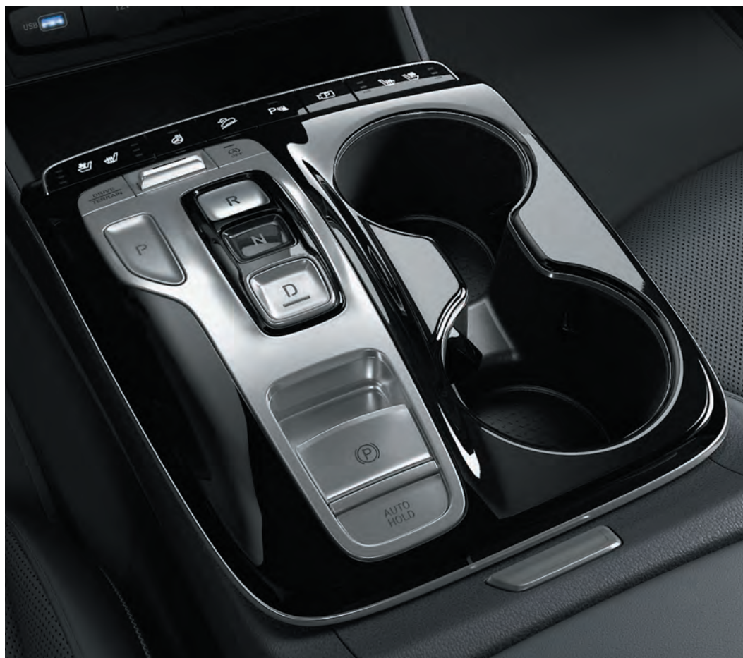
Transmission à commande électrique.
