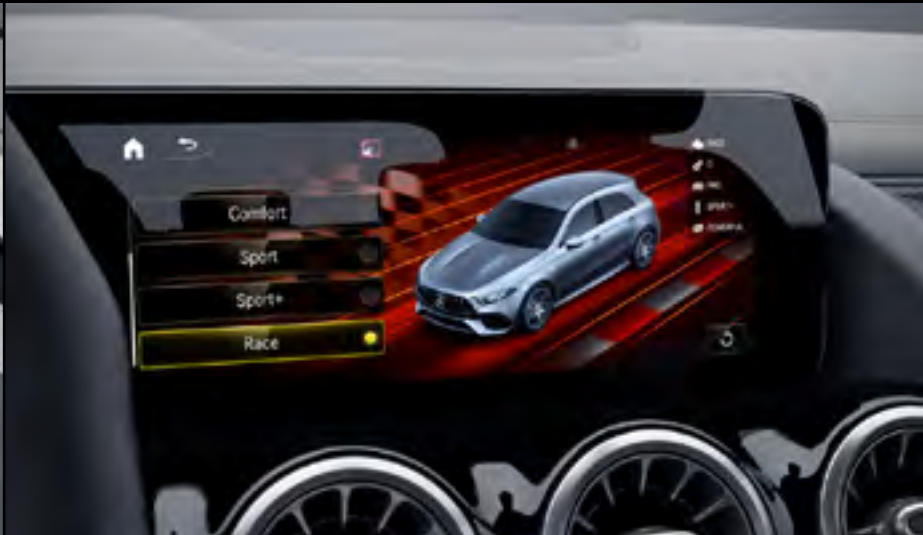
DYNAMIC SELECT AMG avec 6 programmes de conduite : Chaussée glissante, Confort, Sport, Sport+, Individual et RACE
