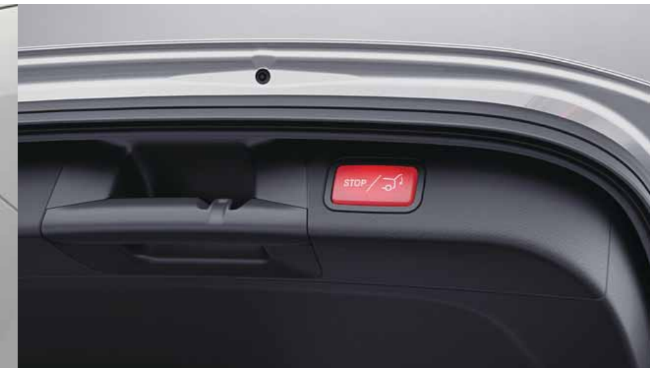
890 - Hayon EASY-PACK à commande électrique
