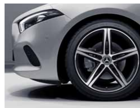
O1R - Jantes alliage 45,7 cm (18") à 5 doubles branches finition noir/naturel brillant Série avec Pack Sport Black Monte 225/45 R18
