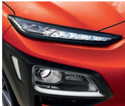
Feux de jour et de position à LED et signature lumineuse exclusive
