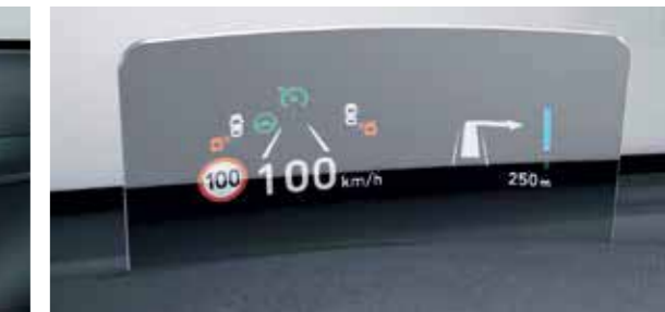
Head-up display (HUD) - Vitesse et navigation projetées à la hauteur des yeux, pour vous aider à conduire en toute sécurité.
