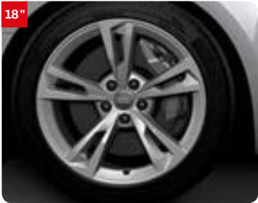
En option : Jantes en aluminium coulé style 5 branches doubles, 8,5 J x 18" Pneus : 245/40 R 18 Code : PRF
