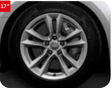
En option : Jantes en aluminium coulé style 5 branches doubles, 7.5 J x 17" Pneus : 225/50 R 17 Code : F66
