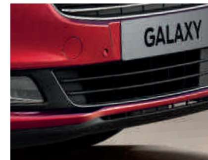
Grille de calandre inférieure avec contour façon chrome (de série)
