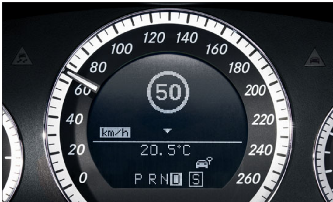
Le rappel de limitation de vitesse signale également les limitations de vitesse temporaires.
