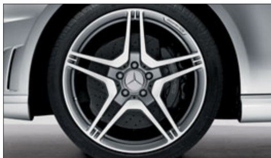
Jante forgée AMG à 5 doubles branches, finition gris titane polie, avec pneus 255/35 R 19 à l'avant et 285/30 R 19 à l'arrière (option sur E 63 AMG).
