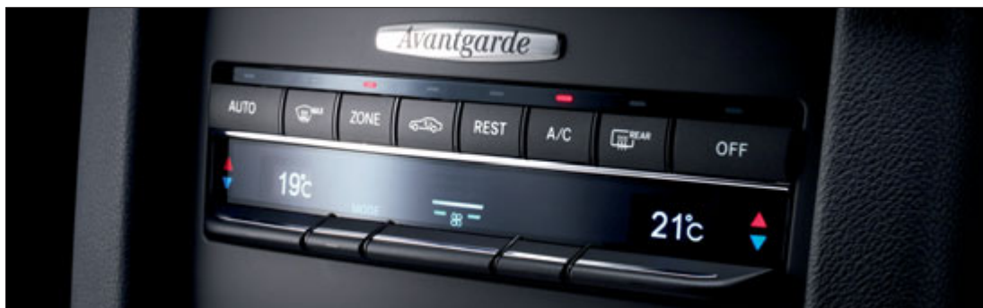
Les éléments de commande de la climatisation automatique confort THERMOTRONIC favorisent une commande intuitive.
