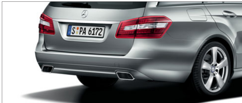
Les sorties trapézoïdales du système d'échappement sont intégrées dans le pare-chocs.
