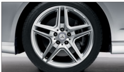
Jante alliage AMG à 5 doubles branches, finition brillante, avec pneus 245/40 R 18 à l'avant et 265/35 R 18 à l'arrière (option, codes 795 et 791).
