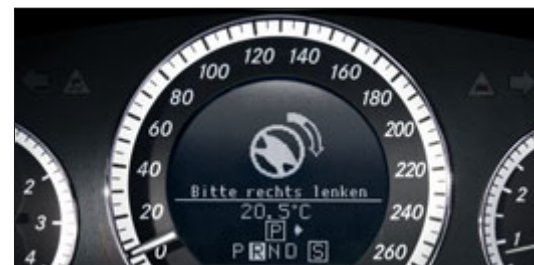
Le stationnement guidé signale les places de parking adéquates au conducteur et lui fournit des indications pour l'aider à se garer.
