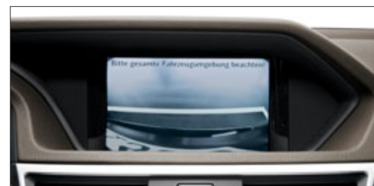
L'objectif grand angle de la caméra de recul filme l'environnement immédiat de la partie arrière du véhicule.
