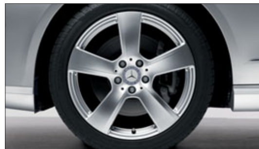
Jante alliage à 5 branches avec pneus 245/40 R 18 à l'avant et 265/35 R 18 à l'arrière (de série avec le Pack Sport Extérieur).
