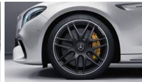
▲ Jantes forgées AMG 51 cm (20") (RTS) et système de freinage en céramique composite AMG hautes performances (B07)
