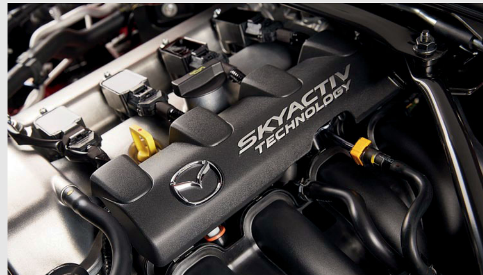
MOTORISATIONS SKYACTIV-G : moteur essence décliné en deux versions (1.5L 131ch et 2.0L 160ch).
