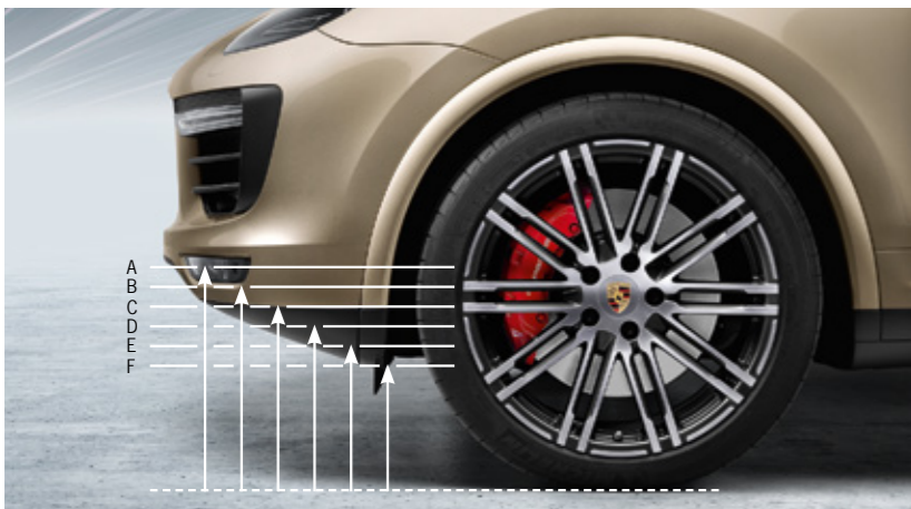
Suspension pneumatique avec PASM. Davantage de dynamique motrice et de confort (page 54) 1)
