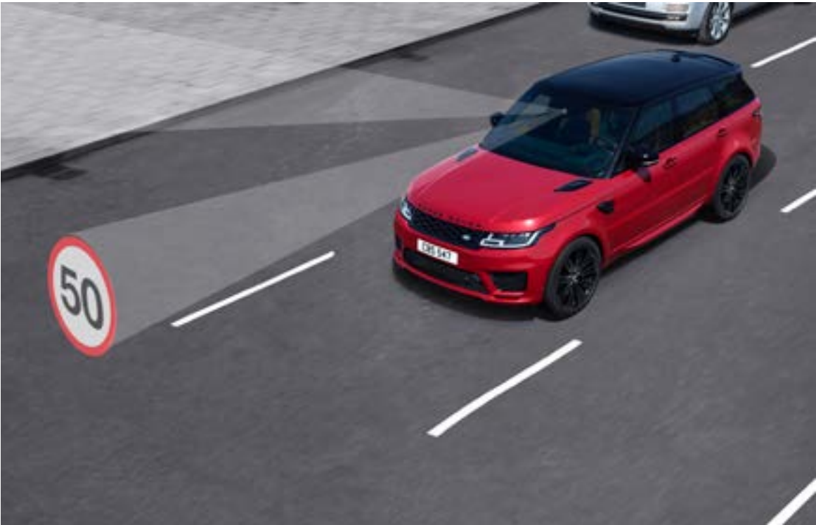
Lecture des panneaux de signalisation avec limiteur de vitesse intelligent
