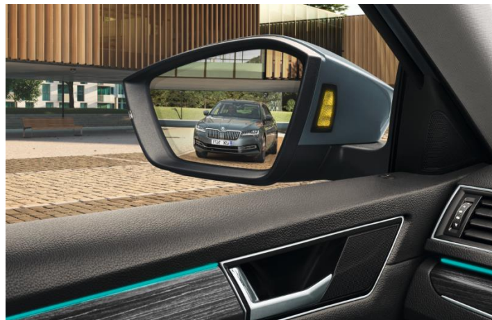
Détecteur d'angles morts (Side Assist)
