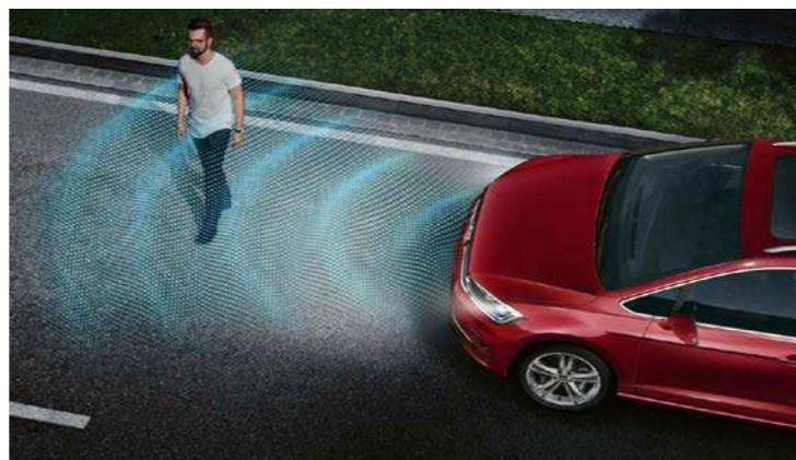
Front Assist avec fonction détection des piétons
