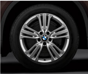
Jantes en alliage léger 19" (48 cm) style 447 à rayons en W avec monte pneumatique mixte. Dimensions : 9 J x 19 à l'avant, pneumatiques 255/50 R 19 ; 10 J x 19 à l'arrière, pneumatiques 285/45 R 19.
