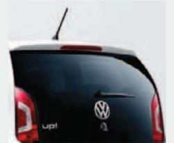
Hayon arrière vitré avec antenne et 3<sup>ème</sup> feu stop
